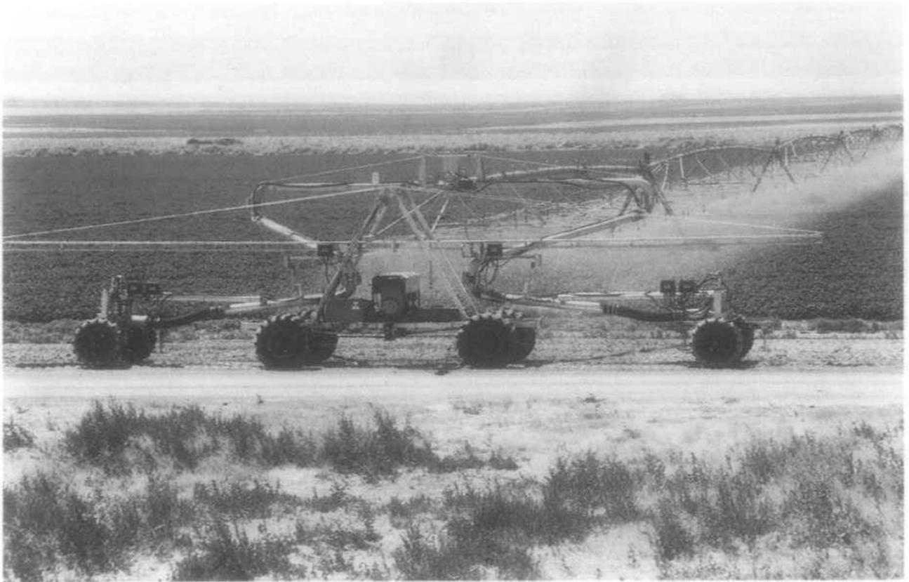
Abb. 10: Wasserverteilung mit Quertraversen (Foto: Valmont)
