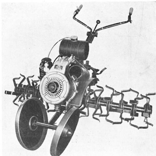
triebtradlos mit langsam drehender Arbeitswelle, ausgestattet mit Spezialhackmessern für alle Bodenverhältnisse, einstellbar auf
